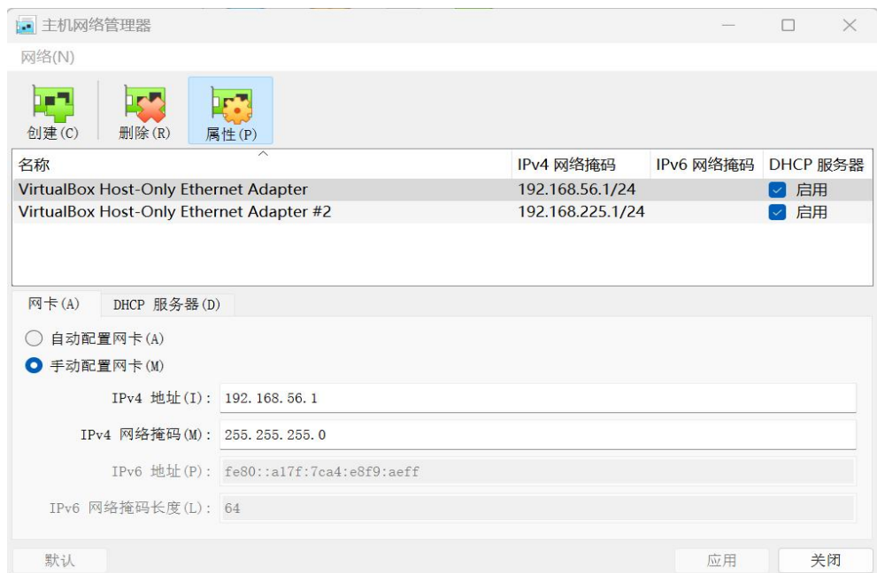
图 3-41 给 VirtualBox 增加一块虚拟网卡
