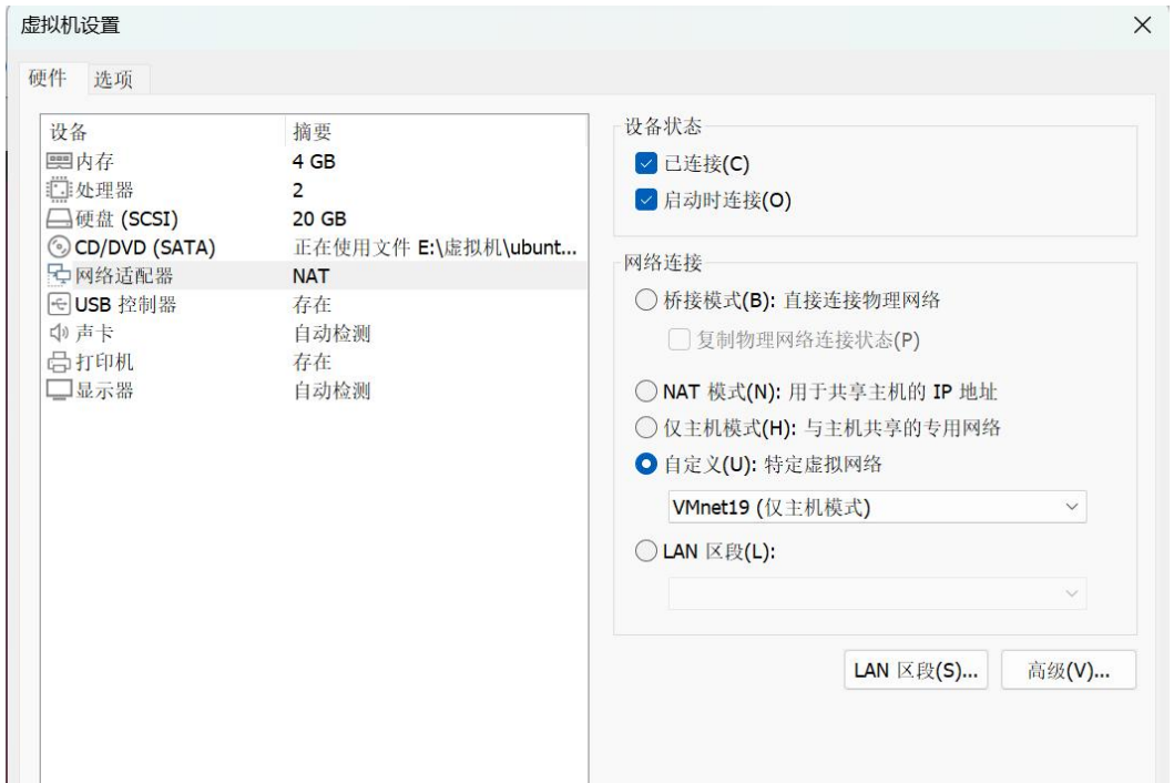
图 4 设置 openstack 虚拟机的网卡为 VMnet19
